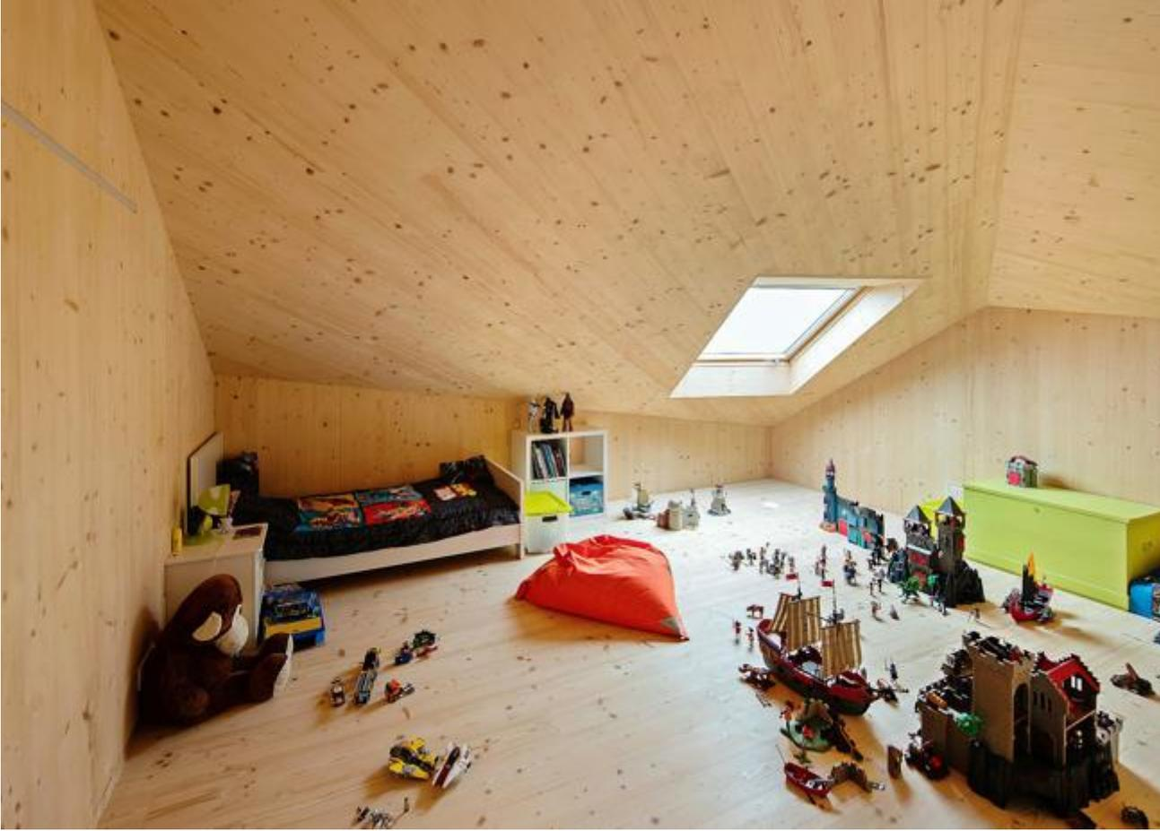
*Les murs, le sol et le toit ont été construits selon la technique du bois massif lamellé collé croisé (ou CLT). La structure fait office de finition et permet un important gain de place à l'intérieur.*
